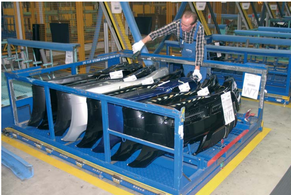
Der Werker prüft die richtige Sequenz der Stoßfänger im Behälter. Nach erfolgreicher Prüfung wird der Behälter zur Verladung freigegeben.
